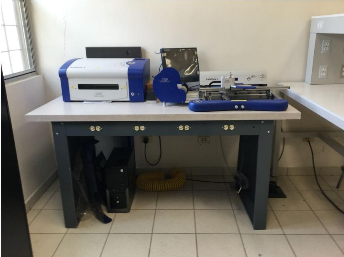
Figura 4. Laboratorio de sistemas digitales. Equipo para fabricar PCB de montaje superficial (soldadura y colocación). Edificio 8D.
