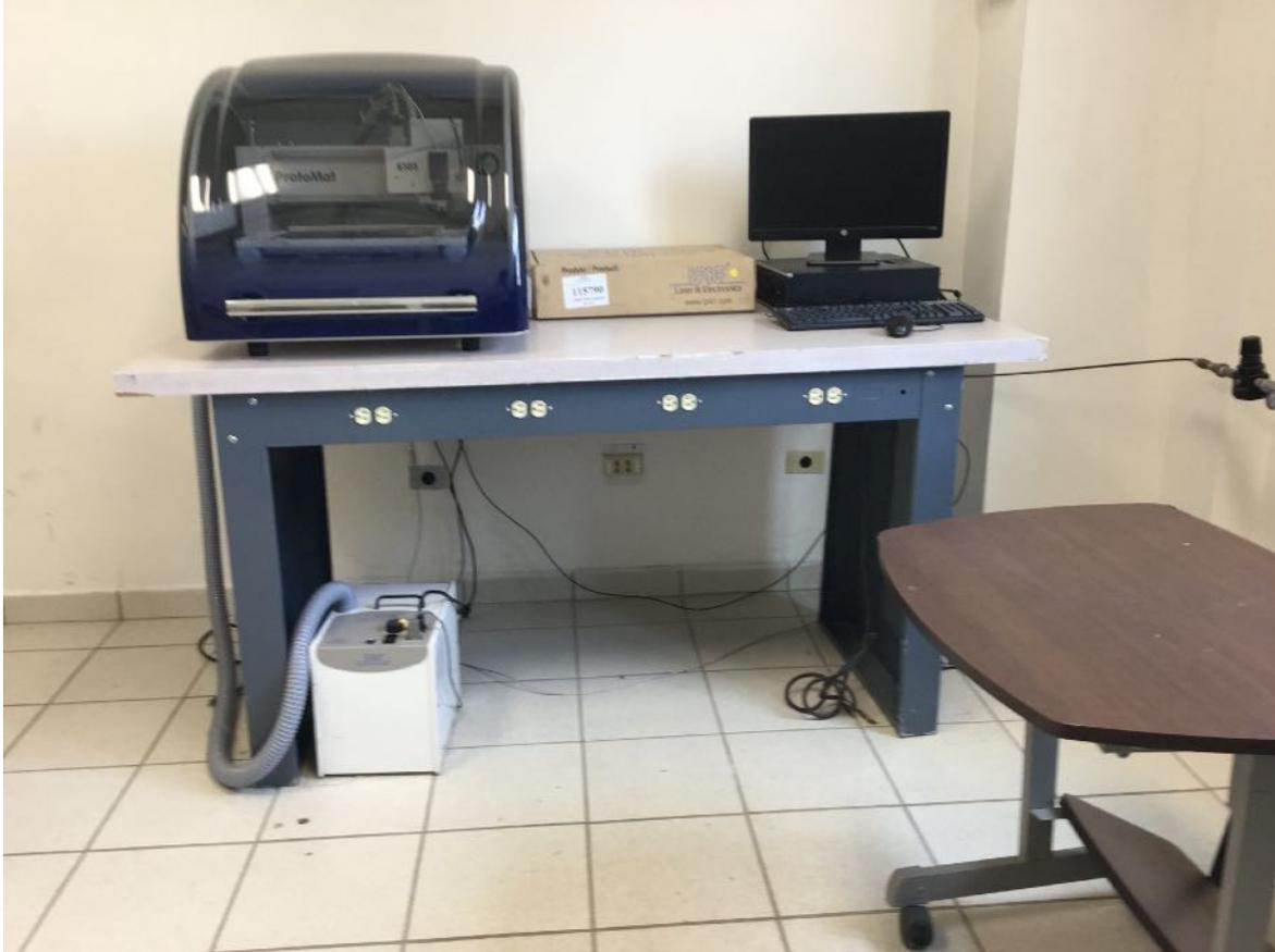
Figura 5. Laboratorio de sistemas digitales. Equipo para fabricar PCB de montaje superficial (Diseño de tarjeta y perforación). Edificio 8D.
