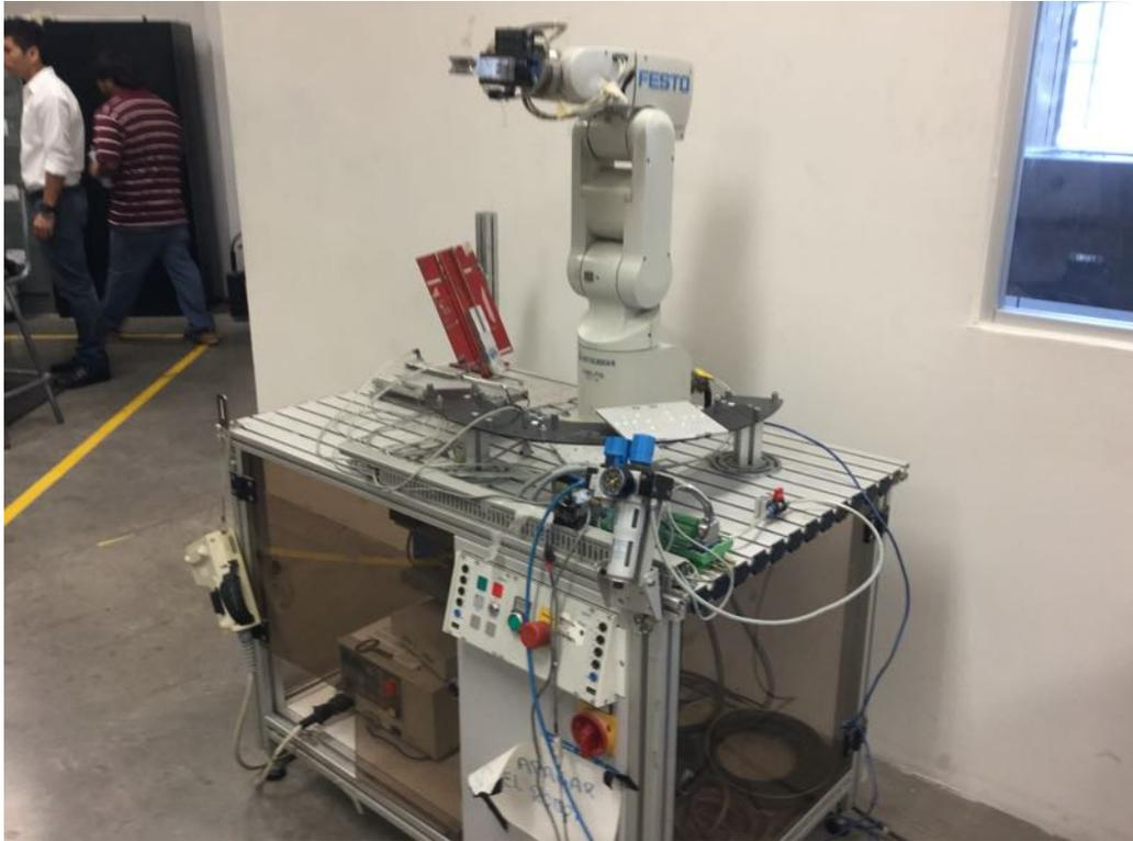
Figura 1. Robot festo en laboratorio de manufactura. Edificio 8D
